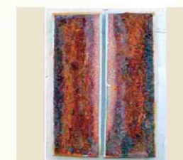
②無処理試験片 【注】①、②は現場発生 同一材料(発錆)を使用
