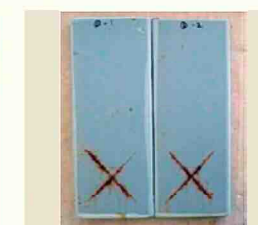
①(ブラスト+塗装) 施工済み試験片
