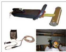
IH式被膜剥離
