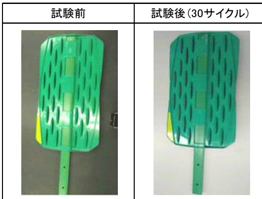
図5. 温度サイクル試験状況
