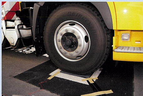
・車両重量25tによる3回踏付試験
