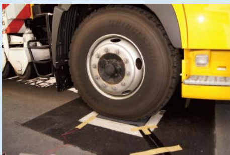
・車両重量25tによる3回踏付試験
